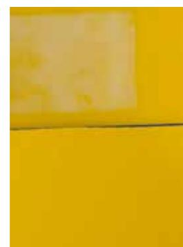
UV-Stabilität im Vergleich. Polyurea-Gelcoat (unten) und konventioneller UP-Gelcoat (oben). Der neue Gelcoat zeigt nahezu keine optische Veränderung nach 500 Stunden UV-B Belastung.
